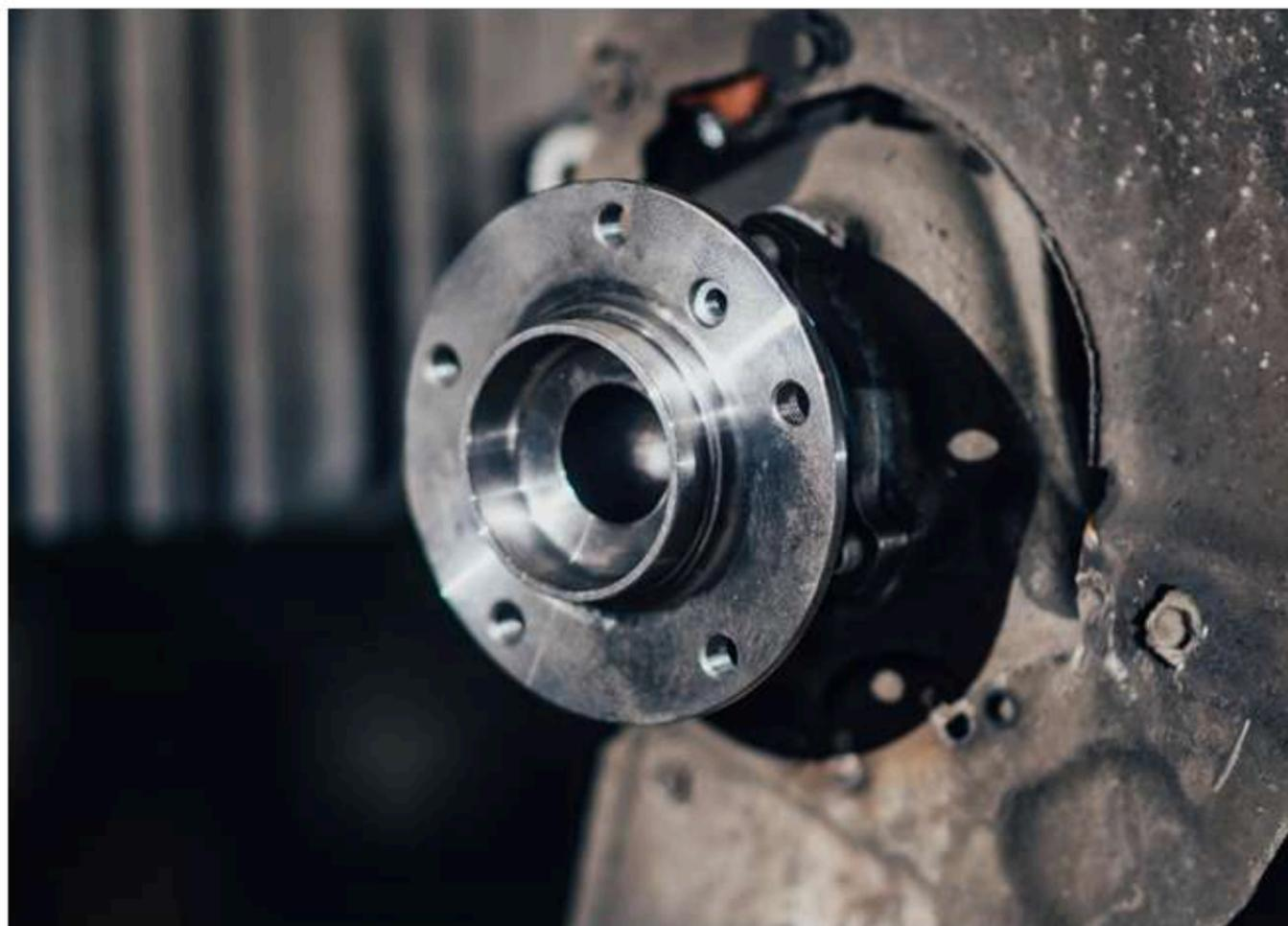
O cubo de roda é montado na manga de eixo e possui rolamentos que suportam o peso do veículo, reduzindo o atrito durante a rotação. Ele é responsável por garantir **um movimento livre e estável das rodas**, permitindo que o veículo se desloque com **segurança e eficiência**.
