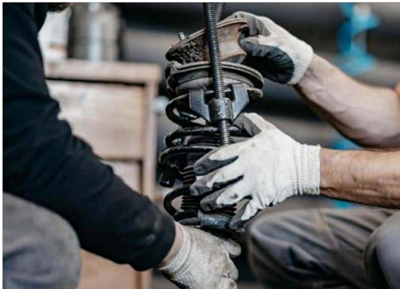
Para que o **desempenho e a durabilidade** do sistema de suspensão sejam aproveitados ao máximo, recomenda-se que o kit e o top kit de suspensão sejam substituídos sempre que houver a **troca dos amortecedores**.
