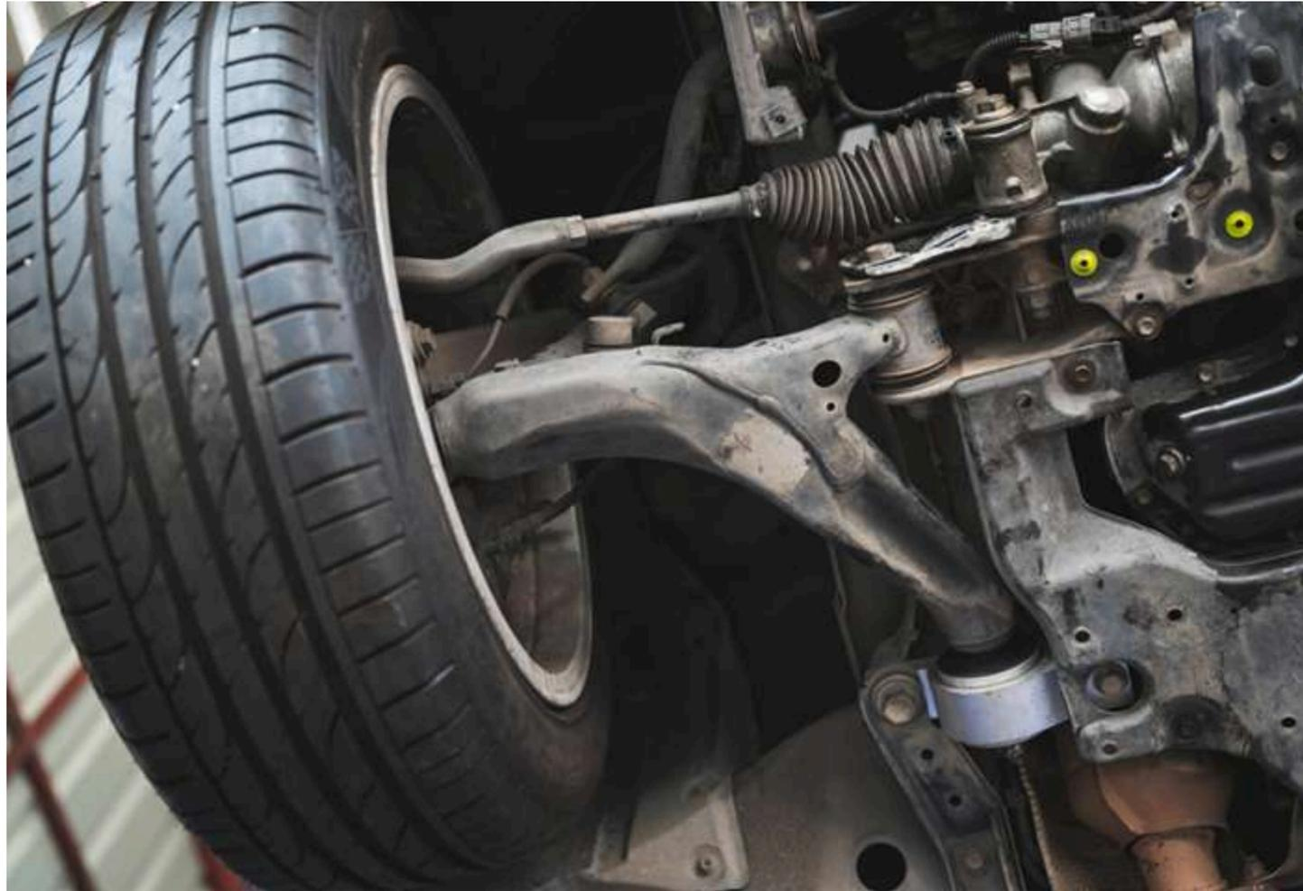
O **excesso de carga e a falta de manutenção** reduzem a vida útil das bandejas. Além disso, **fatores como acúmulo de detritos, contaminação por produtos químicos durante a lavagem do chassi e problemas na rigidez da borracha** também podem afetar sua durabilidade.
